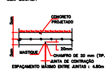
JUNTA DE CONTRAÇÃO SEM ESCALA
